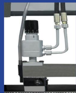
Schnittdruckregelventil, Schnittdruck wird direkt am Sägeband überwacht, Überlastschutz und Standzeitüberwachung
