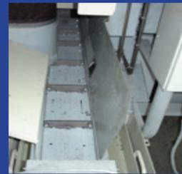
SBA 441/S-CNC-L und SBA 551/S-CNC-L serienmäßig mit integriertem Späneförderer, Spänekanal direkt unter dem Sägeband
