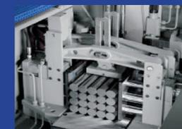
Bündelspannung ( Option ) zusätzliche vertikale Materialspannung, in der Breite und Höhe stufenlos einstellbar.
