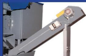
SBA 241/S und SBA 361/S ( Option ) Kratzbandförderer (kurzspanend) Scharnierbandförderer (langspanend) seitlich oder nach vorne austragend
