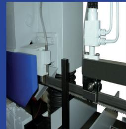
Hartmetall- Gleitführung. Eine Bandführung fest montiert, die zweite wird automatisch auf den Materialquerschnitt eingestellt.
