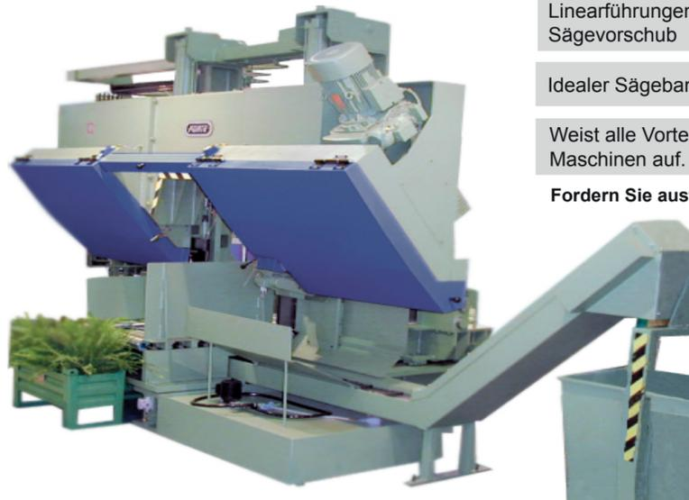
Abb.: Bandsägeautomat SBA 681/S und Späneförderer ( serienmäßig ) , abfahrseitig
