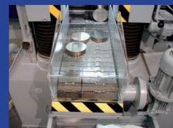
Transportkette für die Entsorgung von Abschnitten ( Option ) nur in Verbindung mit CNC-Steuerung, da auch das Freifahren des Sägebandes enthalten ist.
