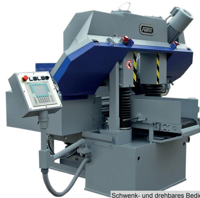
Schwenk- und drehbares Bedienpult für ergonomisch angenehmes Arbeiten in der jeweiligen Bedienposition
