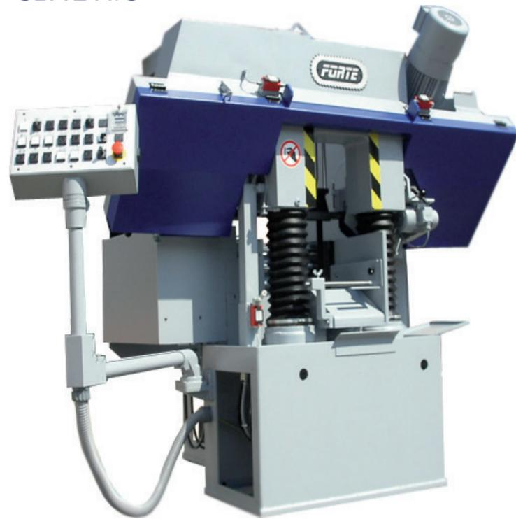
Abb.: Bandsägeautomat SBA 241/S abfahrseitig serienmäßig mit Drucktastensteuerung ( Option CNC-Steuerung )
